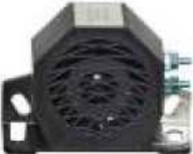
Sirena BA01 DC 12V/24V, 97dB 1 metro atstumu, 5W, Dažnis 960 – 1440 Hz, Išmatavimai: 7,1 x 4,1 x 10,2 cm.
